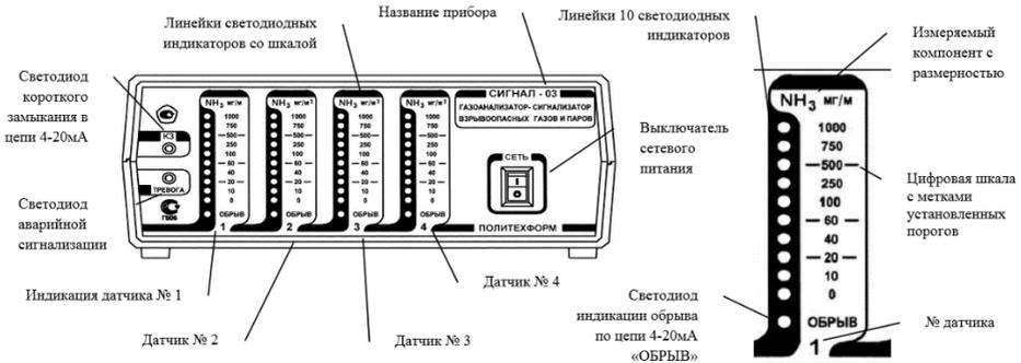
Рисунок 1.1 – Внешний вид передней панели БИ
