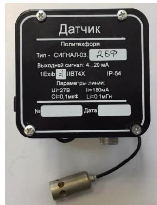
Датчик фланцевый с полупроводниковым сенсором в силуминовом корпусе
