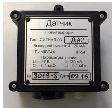
Датчик с электрохимическим сенсором в пластиковом корпусе
