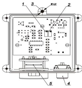
Рисунок В.1 – Датчик с электрохимическим сенсором
