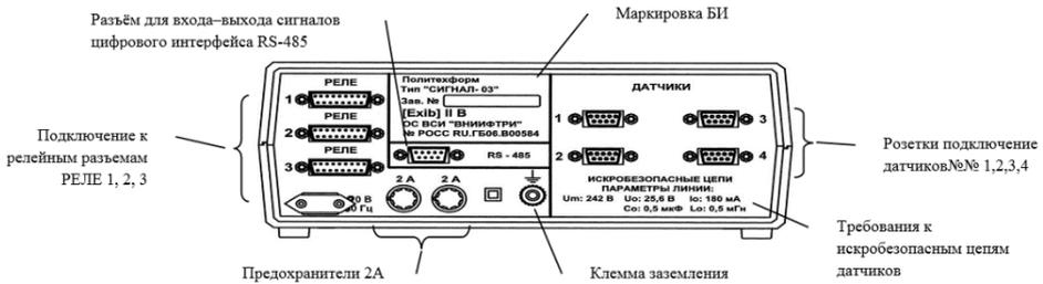
Рисунок 1.2 – Внешний вид задней панели
