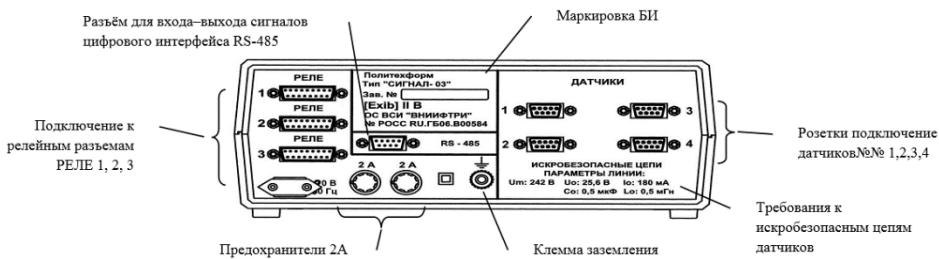
Рисунок 1.2 – Внешний вид задней панели
