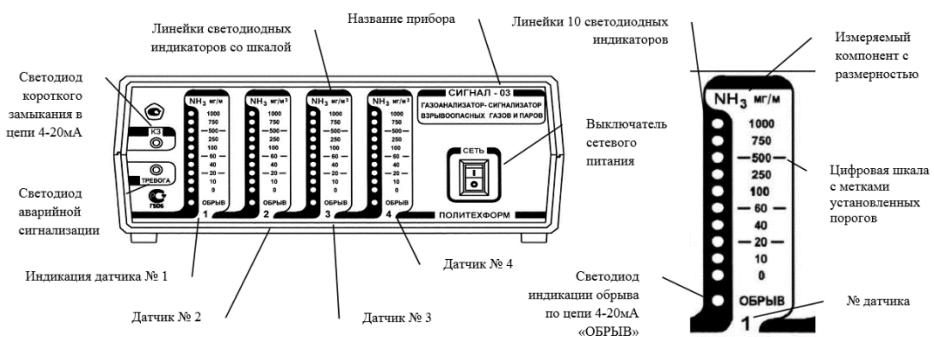
Рисунок 1.1 – Внешний вид передней панели БИ
